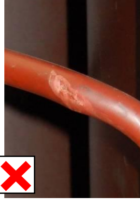
Şek. 11: Yasak! Bir şalt bağlantısının deforme olmuş yalıtımı
