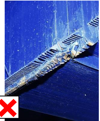
Fig. 13 : Interdit ! Les pointes de noyau de ce joug sont très déformées et se touchent
