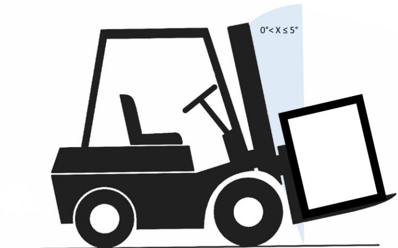
Fig. 9: Ángulo de inclinación para el transporte con carretilla elevadora
